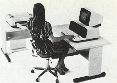
Un Questar/M con stampante a 160 cps, 132 colonne; unità centrale con tastiera, video, un disco fisso da 5 milioni di caratteri, inseriti nel corpo dell'unità centrale. E' questa una delle configurazioni più interessanti, in quanto unica sul mercato. (M. F. B.)
